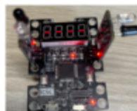
注意传感器的安装方向, (电路板朝内) 如果按错方向会导致设备故障。
